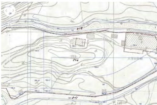
圖 9 30098 建號（泉源路 77 號）建物位置圖與 58 年航測地形圖之套繪圖
